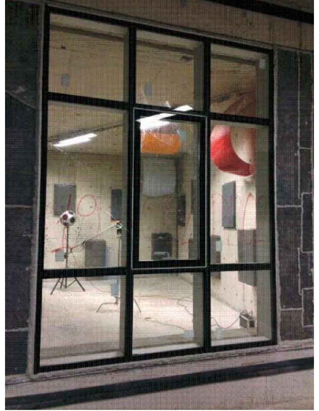
Entegre Cephe / Integrated Curtain Wall Genişlik / Width: 2150 mm Yükseklik / Height: 2820 mm
